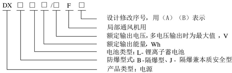
局部通风机用铅酸蓄电池电源装置的产品型号按以下规则编制:
